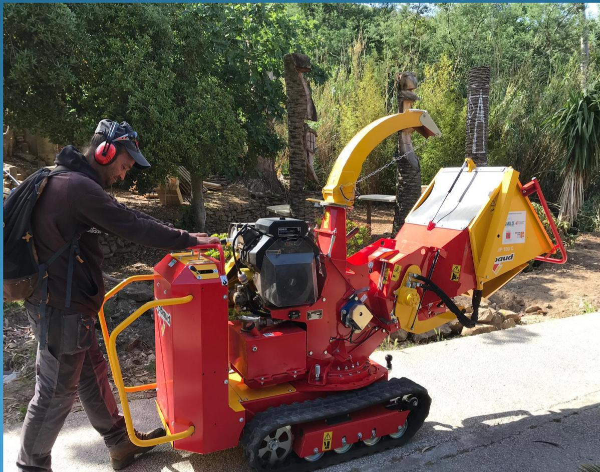
Broyeur Eliet, modèle Minor 4S, léger (65 kg) et portable, destiné à intervenir dans des propriétés d'accès difficile.
